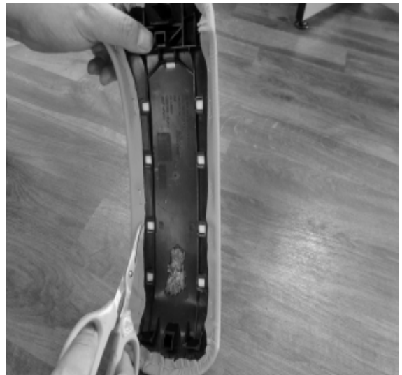
⑤四角の穴の部分に生地がかぶさる場合は、生地をカットして下さい。
