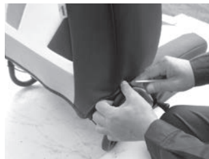
7-1. プラスチックカバーの部分にヘラなどを使用して、押し込んでいきます。
