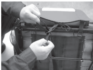
12. バックルに通して絞り込んでいきます。あまり強く絞り込みますと切れる場合がありますので注意して行ってください。
