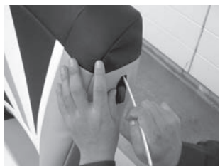
8-1. シート横面についたレバー部分にもヘラなどを使用して入れていきます。
